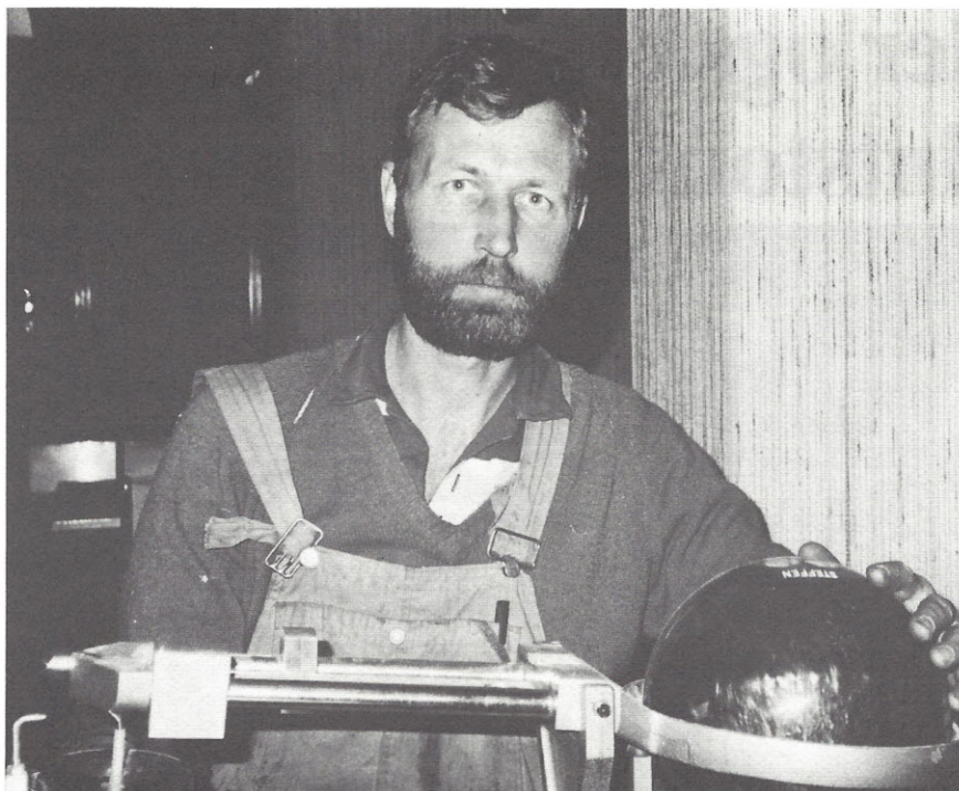
Søren Claes er her i færd med at kontrollere en kugles mål og vægt.
